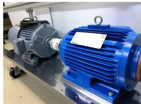
図 1 IPMSM の外観 (写真右)
